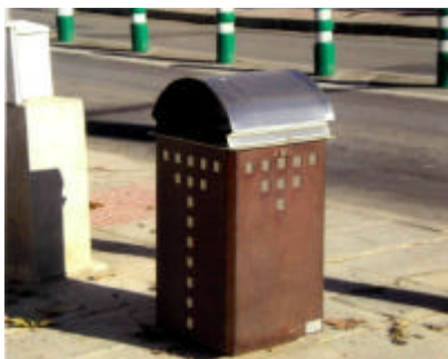
Diseño correcto de papele- ra, proyectada hasta el sue- lo y con boca lateral (Ciudad Real).
