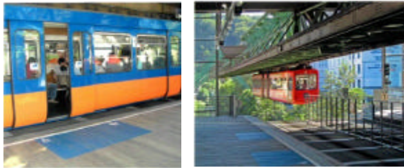
Señalización de borde de andén mediante pavimento táctil en el metro elevado de Wuppertal (Alemania).
